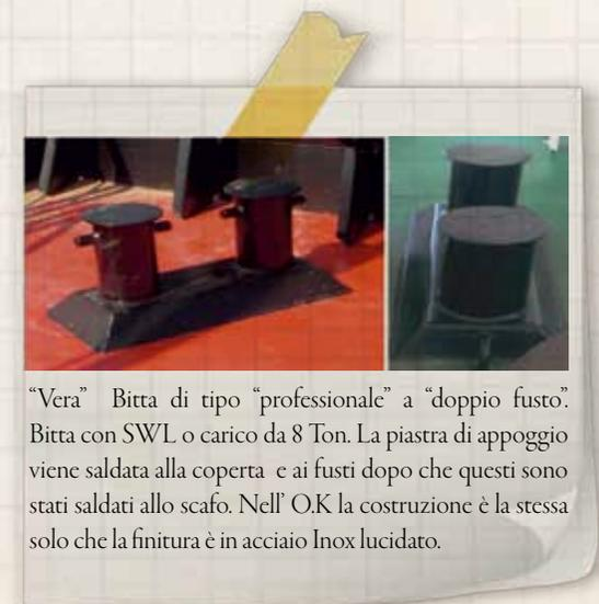
"Vera" Bitta di tipo "professionale" a "doppio fusto". Bitta con SWL o carico da 8 Ton. La piastra di appoggio viene saldata alla coperta e ai fusti dopo che questi sono stati saldati allo scafo. Nell'Ok la costruzione è la stessa solo che la finitura è in acciaio Inox lucidato.
