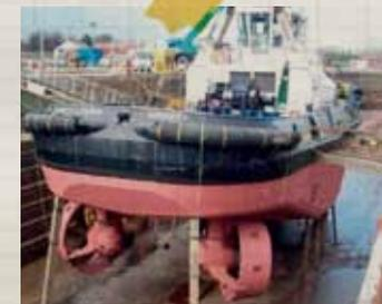
Rimorchiatore con trasmissione Azimutale
