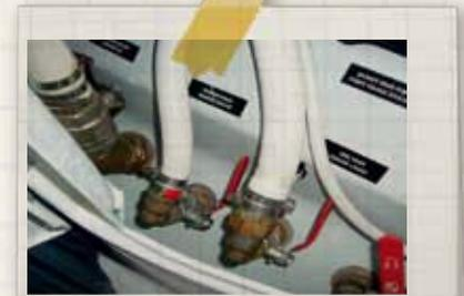
Prese a mare normalmente usate nel Diporto. La semplice rottura di una fascetta provocherebbe danni incalcolabili.
