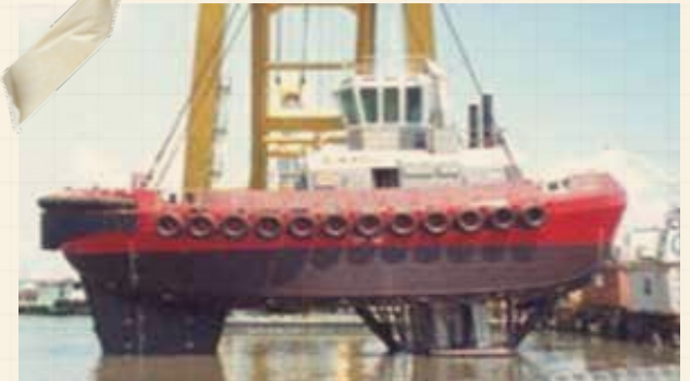
Система Voith с гребными винтами в носу, перпендикулярные корпусу
