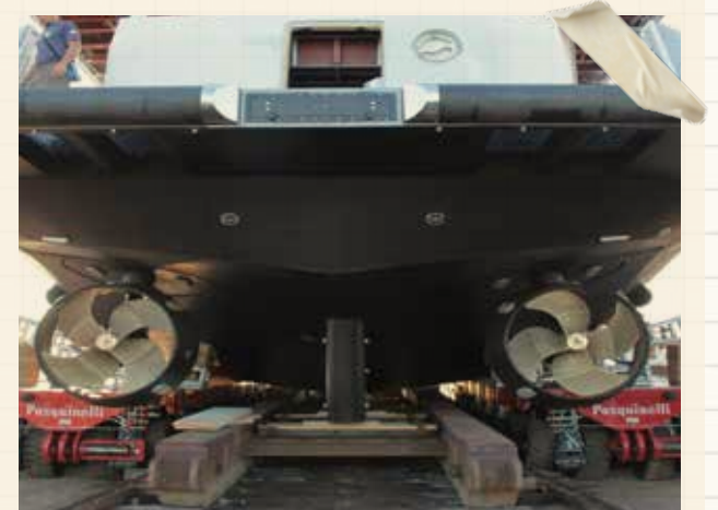
Рис.1 Гребные винты защищенные скегом
