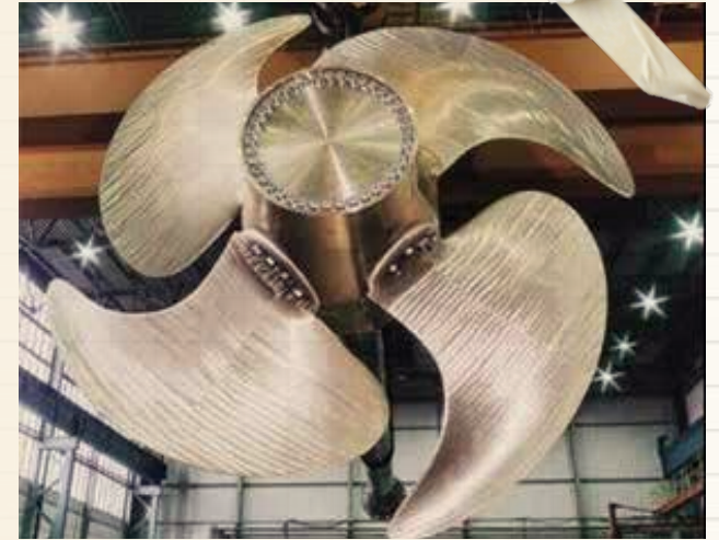
Гребной винт с регулирующим шагом
