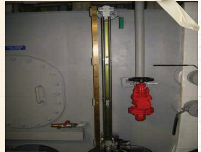
Топливная цистерна с индикатором уровня Day Tank
